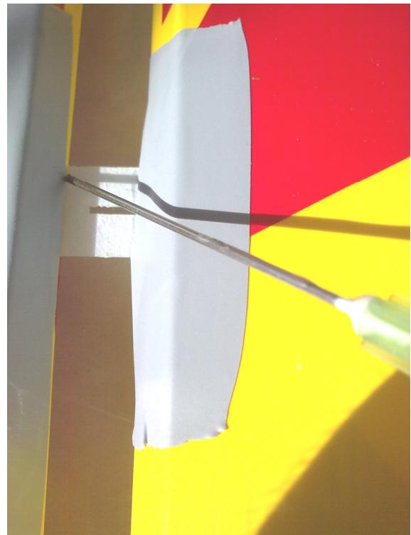
**12. Nach dem Zusammenstecken den überflüssigen Sekundenkleber wieder mit dem Schraubendreher in Richtung Isolierband streichen.**
