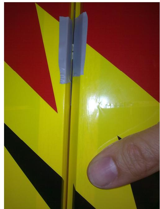
**13. Fertig geklebte Scharniere, durch ziehen am Ruder auf richtigen Sitz und Halt kontrollieren.**
