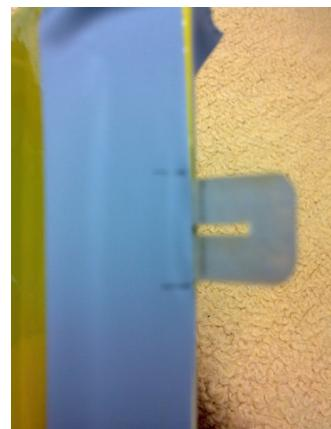
4. Sekundenkleber mit Kanüle am ersten Drittel des Scharniers Oben und Unten dünn auftragen.
