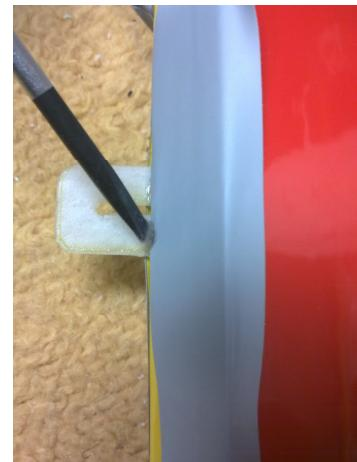
7. Nachdem man die mit überschüssigem Sekundenkleber verschmutzten Isolierbänder abgezogen hat sieht das fertig geklebte Scharnier sauber aus.
