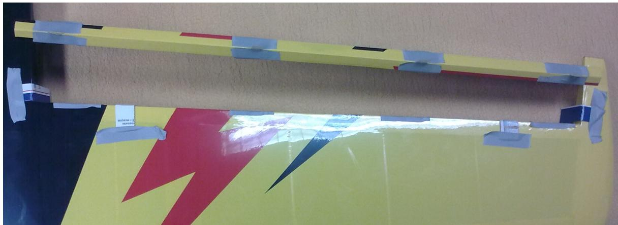
**11. Jetzt werden die Scharniere des Ruders ca. 1-2mm in die Gegenseite gesteckt, nochmals die Spaltmaße links und rechts kontrolliert, und mit der Kanüle das erste Drittel der Scharniere mit Sekundenkleber hauchdünn auf Ober und Unterseite eingestrichen. (Beim Wenden der Fläche darauf achten, dass die Scharniere nicht herausrutschen). Keinen Aktivator verwenden!**
