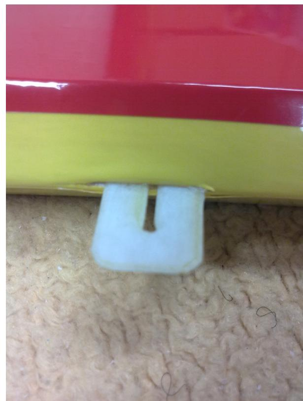
8. Scharniere etwas vor biegen, um die Ruderleichtgängigkeit zu verbessern, auch ein ziehen am Scharnier gewährleistet den Richtigen Sitz, und den dauerhaften Halt dieses.
